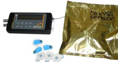
**Figura 5:** Eléctrodos de superfície BLUE SENSOR<sup>®</sup> e sistema de EMG MEGA ELECTRONICS<sup>®</sup>, utilizados para o registo electromiográfico.
