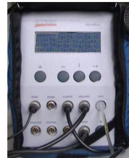
**Figura 4:** Analisador de gases MetaMax, utilizado para a determinação directa de VO<sub>2</sub>máx
