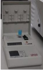
**Figura 10:** Miniespectrofotómetro DR. LANGE<sup>®</sup> mod. LP20, utilizado para determinar a quantidade de lactato no sangue
