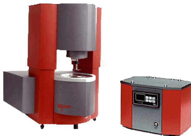
Figura 2.5: Imagem do equipamento usado nos estudo reológicos – Reómetro Stress Tech da Marca Reologica.
