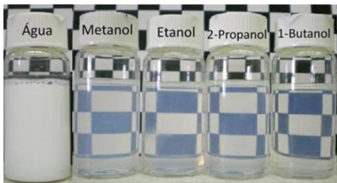
Figura 3.22: Turbidez de soluções de 2.0% (p/p) de HM-PAA em diferentes solventes.
