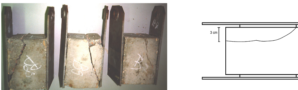
Figura 2.53 – Superfície de rotura observada nos ensaios a 20°C.
