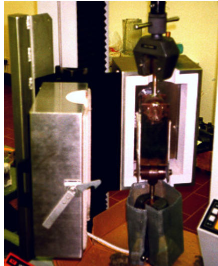
Figura 2.17 - Forno utilizado nos ensaios a quente da 1ª fase.
