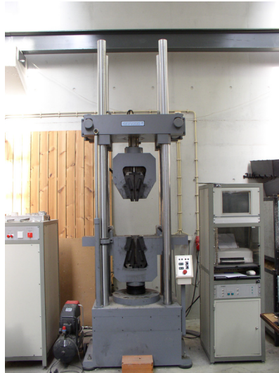
Figura 2.16 – Máquina de ensaio universal utilizada na 2ª fase.
