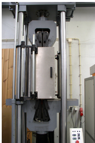
Figura 2.18 – Forno utilizado nos ensaios a quente da 2ª fase: a) forno acoplado à máquina de ensaio; b) provete no interior do forno.
