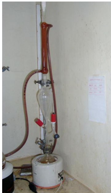
Figura 5.1: Esquema da montagem da destilação para secagem de solventes.
