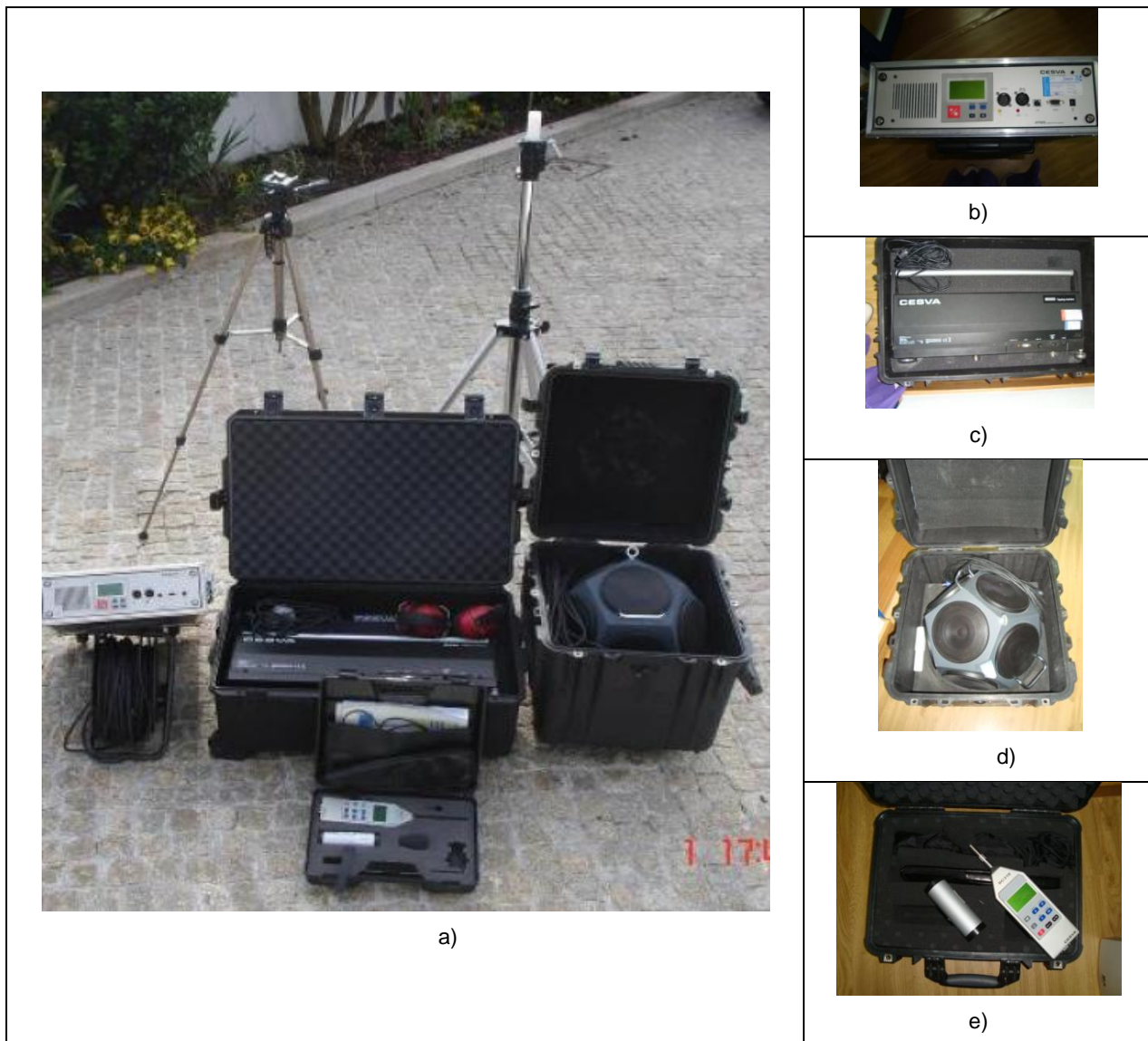
Figura 3.1 Fotografias de alguns dos equipamentos utilizados nos ensaios acústicos: a) ensemble de equipamentos utilizados em acústica; b) pré-amplificador; c) máquina de percussão; d) Fonte omnidireccional e e) Sonómetro analisador e calibrador acústico.
