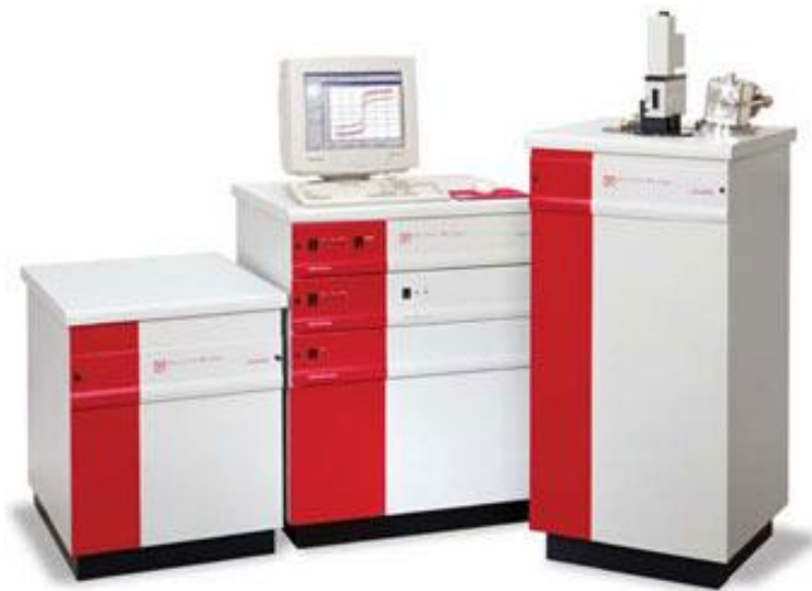
Figura 4.9: Magnetómetro MPMS (R) utilizado na Universidade de Valência. [Fonte: www.qdusa.com ]
