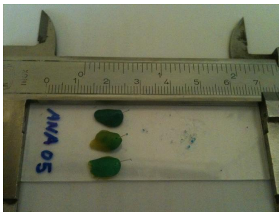
Figura 5.3: Suporte do monocristal, base em plasticina, agulha de vidro e na ponta o cristal.
