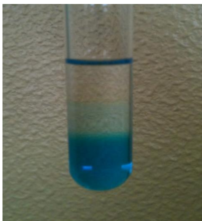
Figura 5.1: Técnica do Tubo de ensaio - disposição das camadas na técnica do tubo de ensaio (de cima para baixo) camada 1: ligando + H 2 O; camada 2: etanol + H 2 O; camada 3: sal metálico + etanol.
