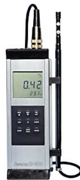
Figura 5.6 – Unidade SwemaAir 300 e sonda SWA31 utilizadas para monitorizar a velocidade inicial do jacto durante a fase de calibração do módulo electrónico de comando e controlo da cortina CC 120.
