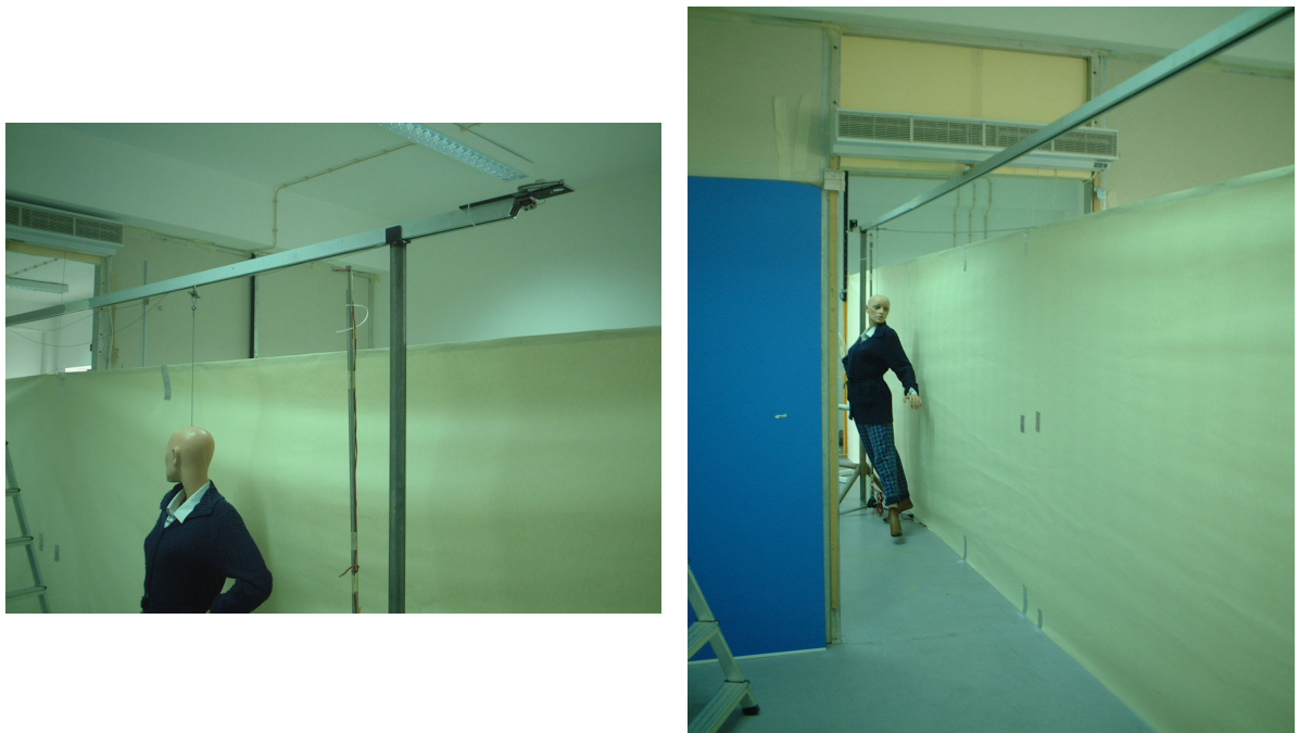
Figura 4.30 – Duas fotografias tirada ao sistema de suporte da Roberta durante a montagem da instalação experimental. Na imagem da esquerda pode ver-se o fio de aço que a segura ao carrinho que circula por dentro da calha bem como o local na extremidade da mesma onde se encaixa o motor de passo que acciona todo o sistema. Na imagem da direita pode ver-se o modo como se apoia centralmente a calha de suporte da Roberta .
