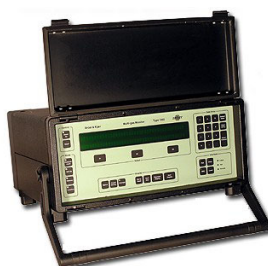
Figura 4.15 – Aspecto geral do Brüel & Kjær Photoacoustic Multi-gas Monitor type 1302™ utilizado nos ensaios.
