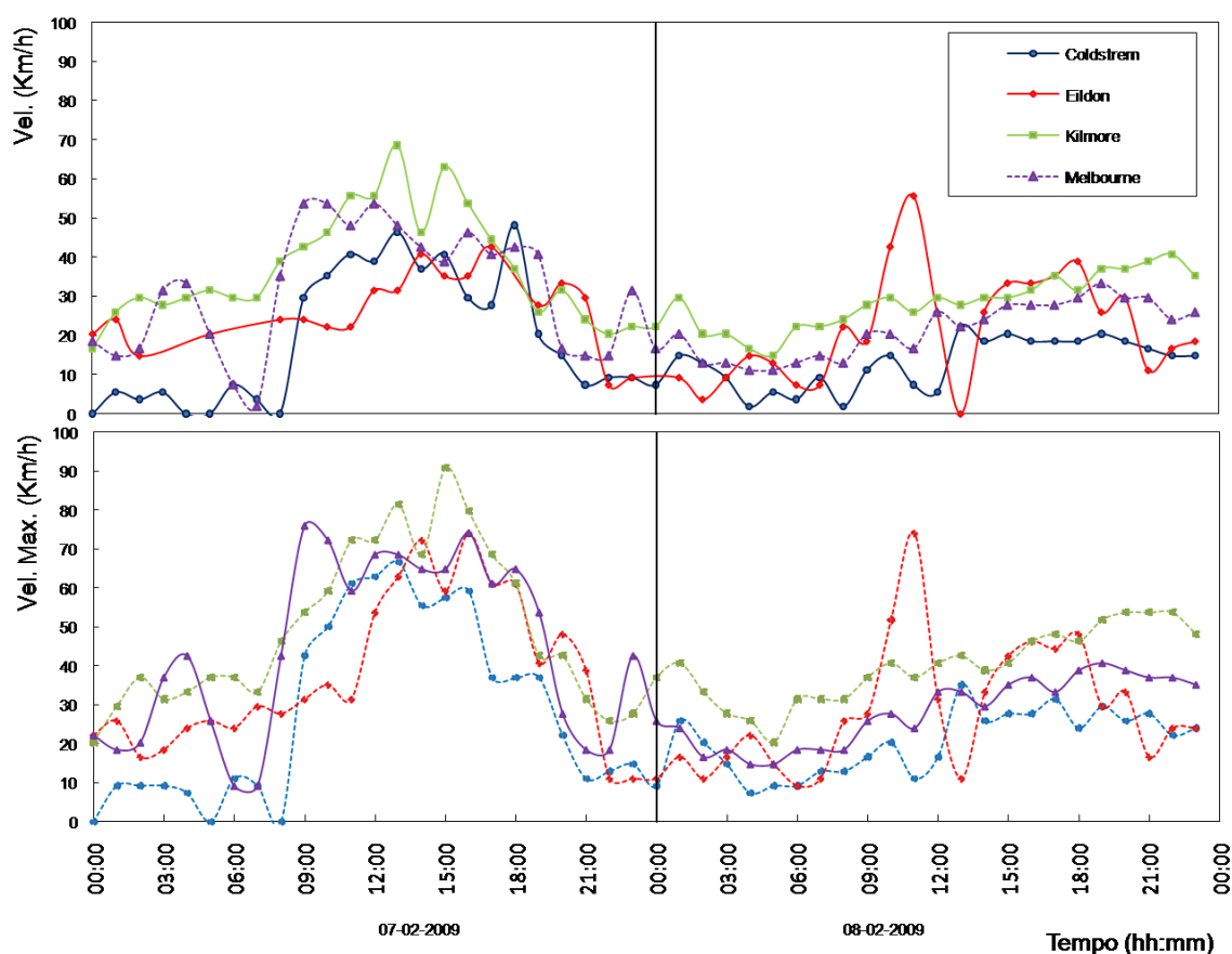
Figura 2.15 – Velocidade média e velocidade máxima do vento registada nas estações meteorológicas que circundam a área ardida. (Fonte: CRC)
