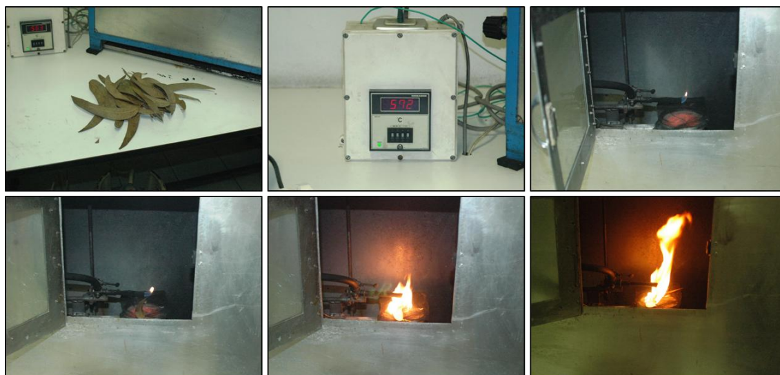
Figura 3.6 – Teste de inflamabilidade com recurso a um epirradiador.
