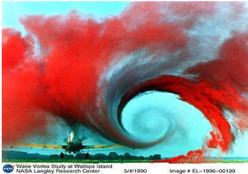
Figura 9 - escoamento turbulento giratório do ar associado ao movimento de aeronaves.
