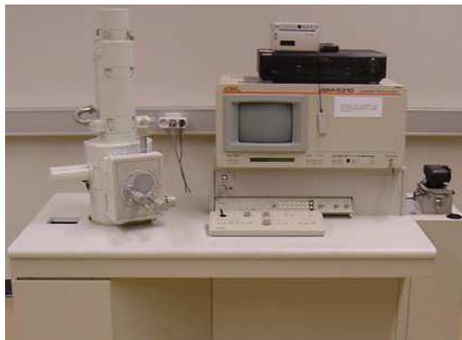
**Figura 19 - Microscópio electrónico de varrimento.**
