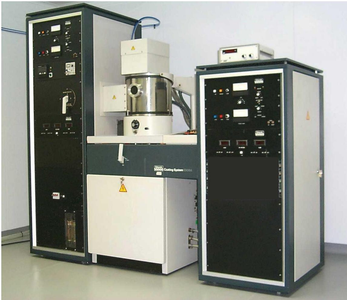
Figura 15 - Equipamento de pulverização catódica - Edwards Coating System E306A.
