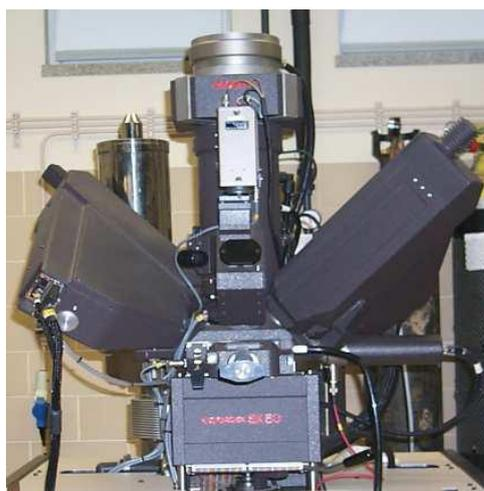
**Figura 16 - Microsonda electrónica (Cameca, modelo camebax SX50).**
