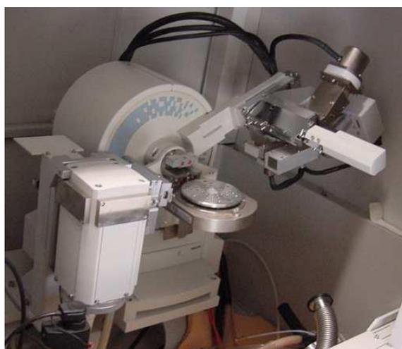
Figura 21 - Difratômetro de raios-X Philips modelo X'Pert.
