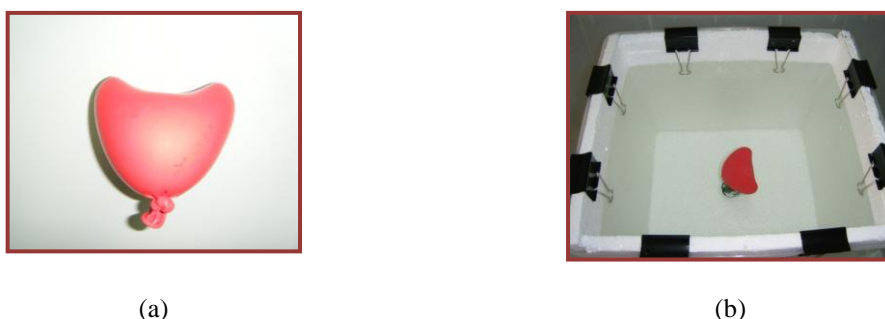
Figura 5.2.1 : Imagens reais do balão usado na experimentação: (a) forma do balão e (b) posição estática do balão dentro da tina com água.
