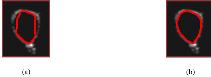
Figura 4.2.3.2 : Evolução da segmentação realizada pela snake numa imagem ecográfica: (a) numa fase inicial e (b) numa fase final.
