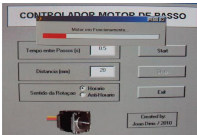
Figura 8.6 - Ilustração da interface gráfica do software de controlo do motor de passo.
