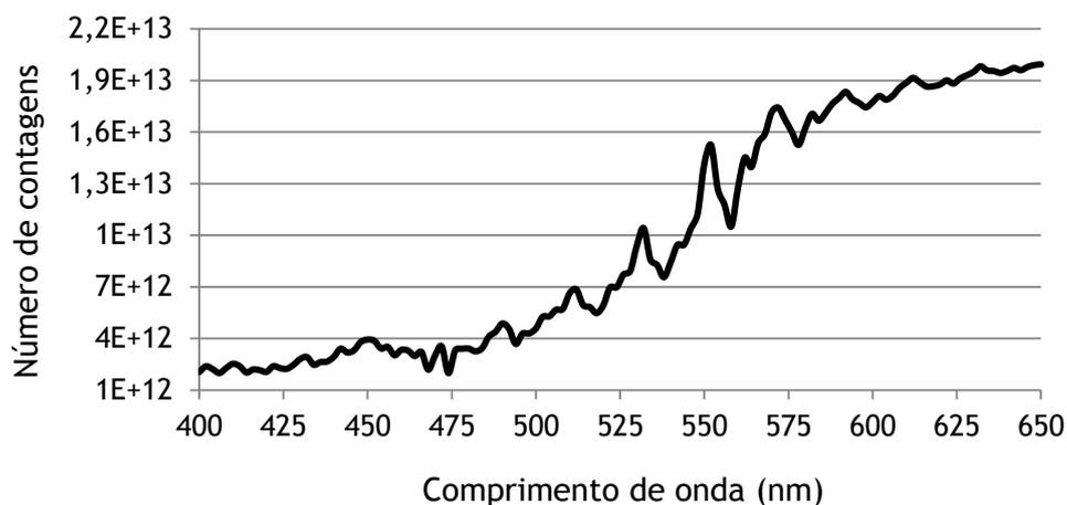
Gráfico 5.1 - Espectro de emissão do LED. Medição feita no espectrômetro SPEX (IBILI - FMUC)
