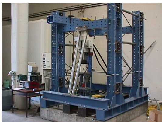
Figura 4.3 – Ensaio de “pullout”: a) equipamento de ensaio; b) esquema do ensaio.
