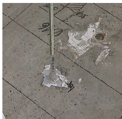
Figura 4.9 –Modos de rotura obtidos em laboratório (varão 12mm): a) rotura betão-cola; b) rotura no aço; d) rotura na colagem.
