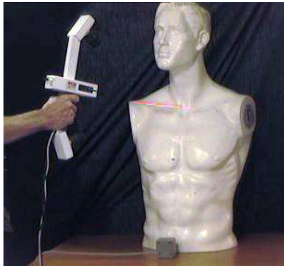
Figura 1.25: O HLS/Polhemus FastSCAN (da ARANZ/Polhemus) – um sistema de scanning 3D portátil transportado manualmente ( “handheld” ) [Polhemus/ARANZ 2000].
