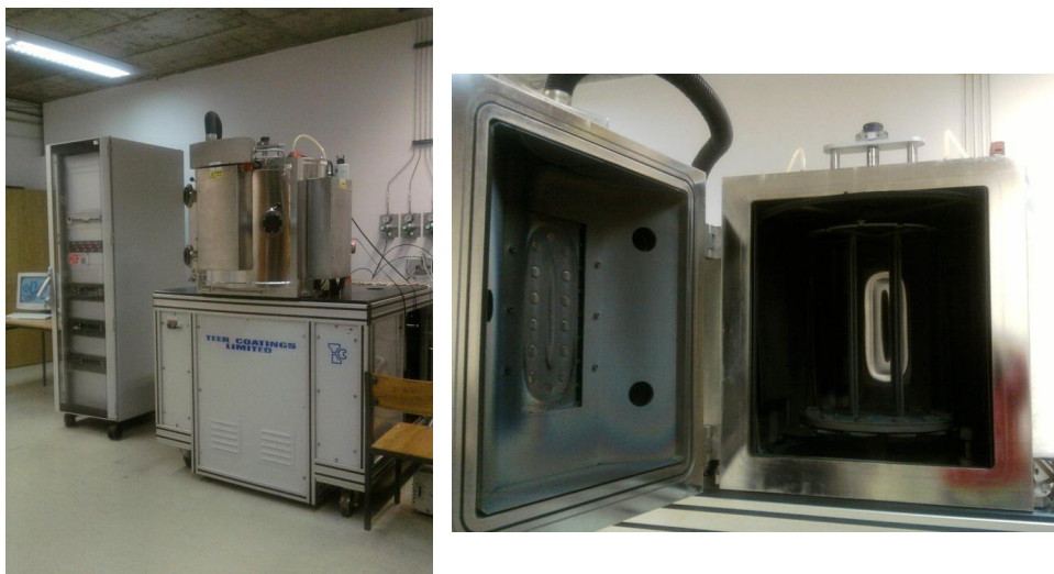
Fig. 2.1 Fotografias da máquina de deposição e da câmara de deposição.
