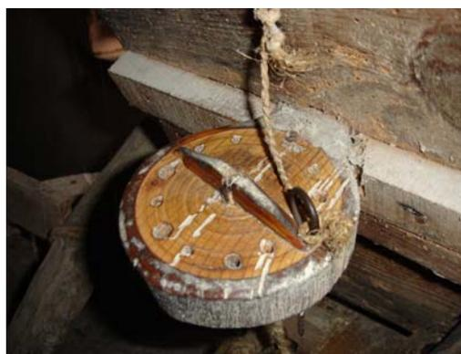
**Fig. 67 - Regulador para controlar a quantidade de milho da moega para as pedras**
