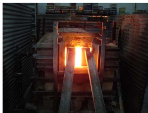
**Fig. 99 - Forno onde o vidro está a fundir**
