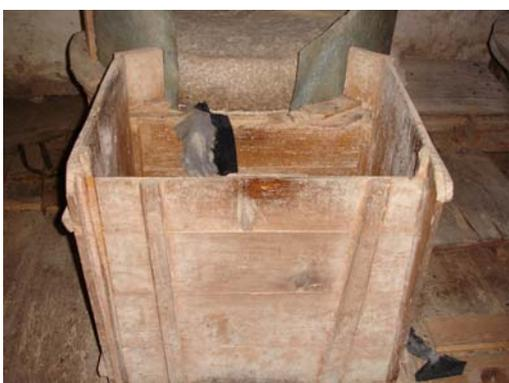
**Fig. 68 - Caixa de madeira onde cai a farinha depois de moída**
