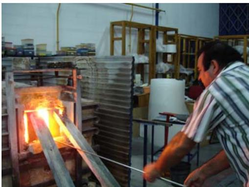
**Fig. 102 - "Colher" o vidro do forno**
