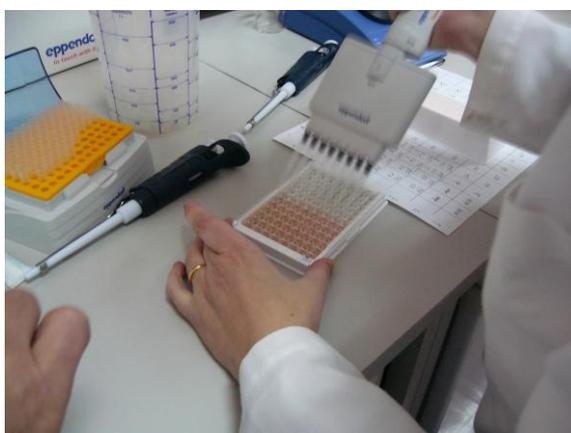
8. Colocação de 200 microlitros da solução anterior em cada poço, com uma pipeta *Multichanel “Eppendorf Research”* com 8 pontas (com uma capacidade de 30 a 300 microlitros).
