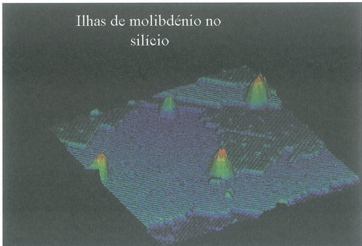
Figura 13. Ilhas de dimensão nanométrica de molibdênio no silício, observadas com um STM
