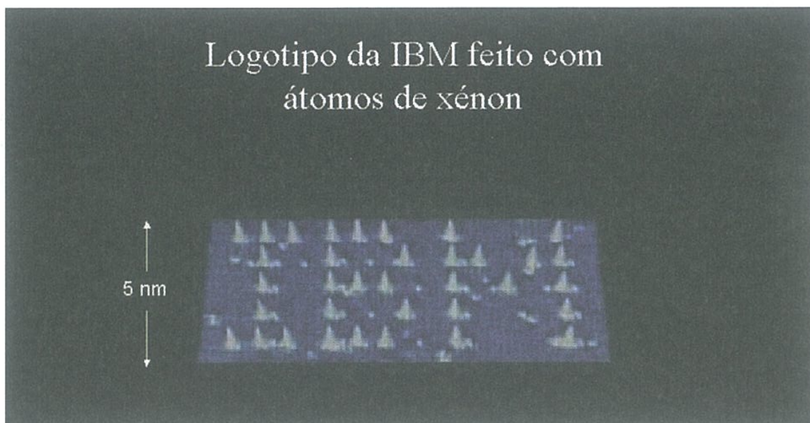
Figura 7. Logotipo da IBM feito com átomos de xénon por Donald Eigler e a sua equipa dos laboratórios da IBM em Zurique.
