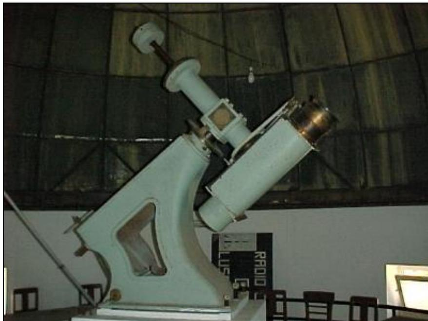
**Fig. 24 Espectrógrafo estelar**
