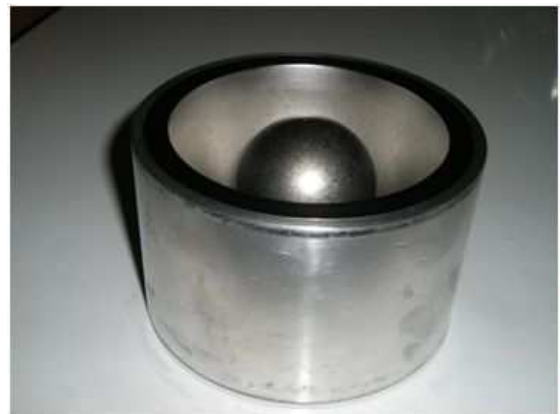
Figura 3.4 Fotografias do moinho utilizado, Fritsch PO ball mill , e do contentor com a bola dentro, onde se pode observar a relação de tamanho entre estes.
