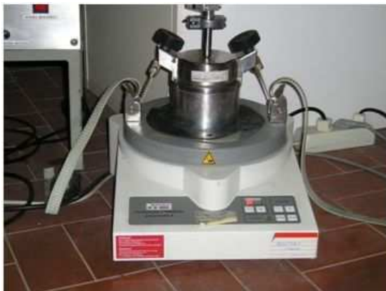
Figura 3.4 Fotografias do moinho utilizado, Fritsch PO ball mill , e do contentor com a bola dentro, onde se pode observar a relação de tamanho entre estes.
