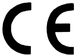
Figura 1 Símbolo que representa a conformidade com as directivas emitidas pela União Europeia.
