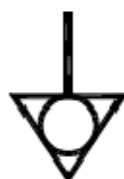
Figura 39 Símbolo que identifica os terminais que, quando juntamente, fazem com que as diversas partes do equipamento fiquem ao mesmo potencia.
