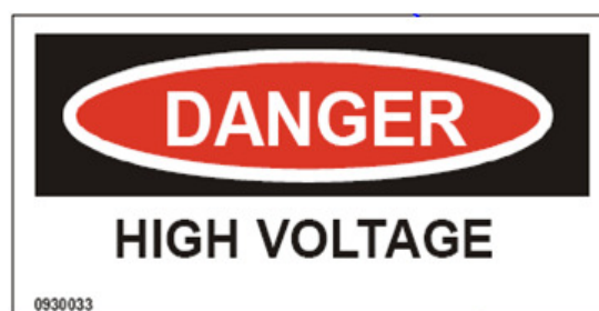
Figura 58 Etiqueta que identifica zonas do equipamento que possuem altas tensões.
