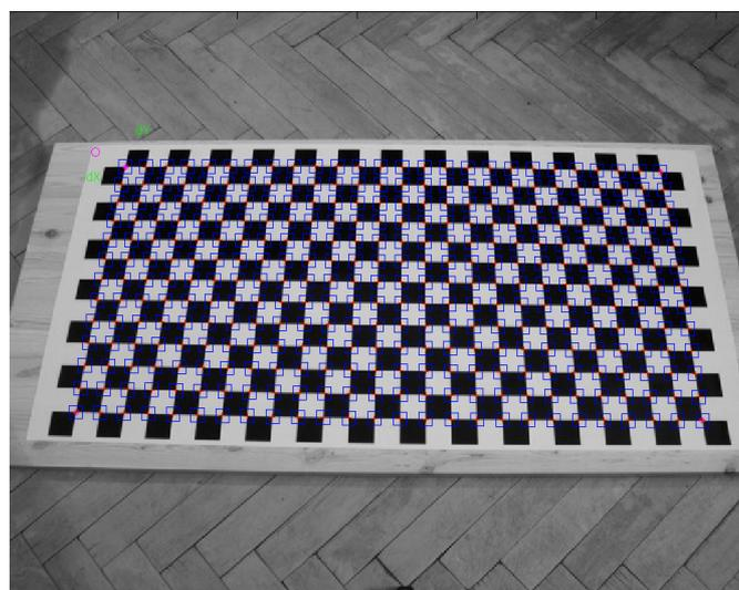
**Figura 4.5:** Resultado da detecção de cantos de uma grelha obtido pela toolbox de calibração de câmaras de Bouguet.
