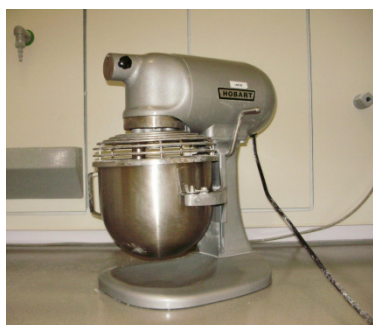
Figura 6.2: Misturador planetário para mistura e preparação de pastas de PVC (cortesia CIRES, S.A.).
