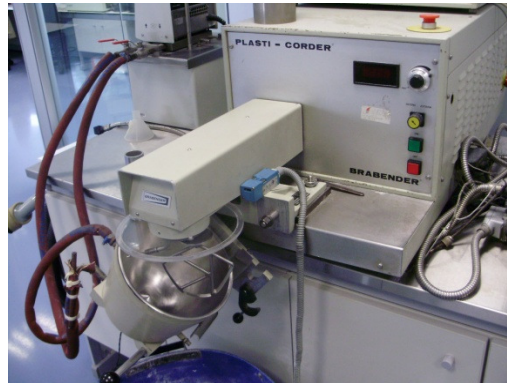
Figura 10.2: Misturadora planetária para produção dos compostos (Plasti-Corder Planetary Mixer Type P600) (cortesia CIRES, S.A.).
