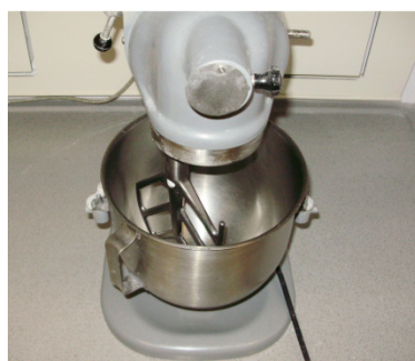
Figura 6.2: Misturador planetário para mistura e preparação de pastas de PVC (cortesia CIRES, S.A.).
