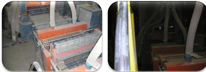
Na 2.<sup>a</sup> fase, após a saída do secador, o material ainda cru, mas seco, entra nas linhas de vidragem. Nestas linhas, o material ao circular em correias é soprado para tirar quaisquer poeiras que existam. Seguidamente leva uma matéria-prima que é engobe, e depois outra que é vidro cerâmico. No caso de ser decorado, passa por máquinas serigráficas podendo levar tintas e corantes. Estas correias levam o material depois de vidrado e decorado, para vagonas afim de entrar no forno para cozer.
