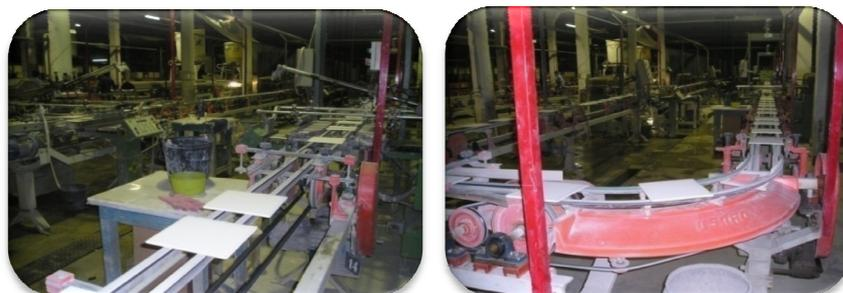
Na 3.<sup>a</sup> fase, o azulejo colocado dentro do forno tem aproximadamente um ciclo de cozedura de 40 minutos e ao sair deste, é descarregado automaticamente por uma máquina chamada Cematik, para cestos de ferro.
