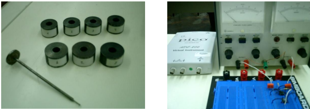
Figura 4 – À direita, foto da montagem utilizada para calibrar o sensor FSS . À esquerda, foto das massas de referência utilizadas para a calibração.
