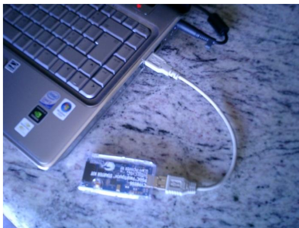
Figura 21 – Foto do Hub do projecto, formado pela placa FTFC do kit CY3271 e por um cabo USB.
