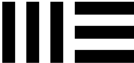
Figura 35 – Um alvo de barras típico, com N linhas por milímetro [18].
