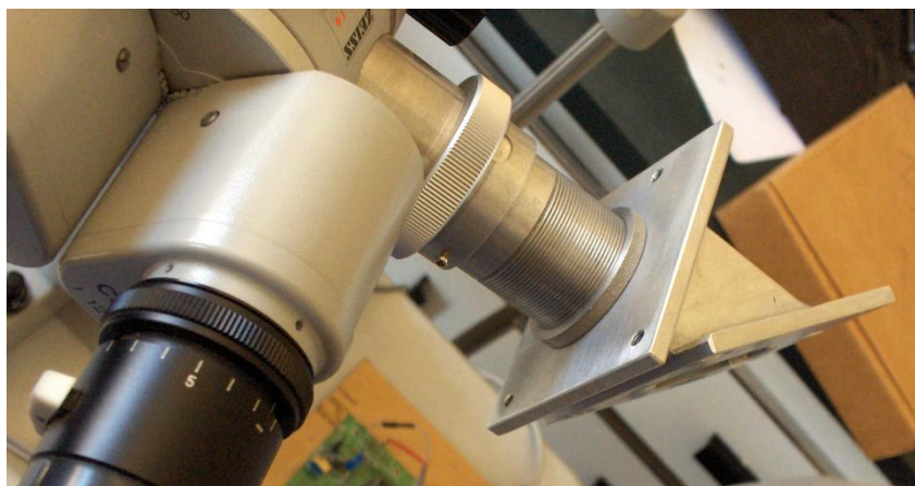
Figura 25 – Fotografia do desviador angular do novo PAF.
