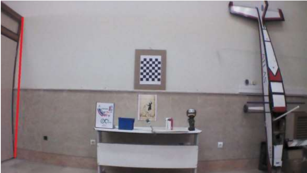
شکل 4-39 مقایسه تصویر خام ربات که درب را به صورت منحنی نمایش داده است با خط قرمز صاف
