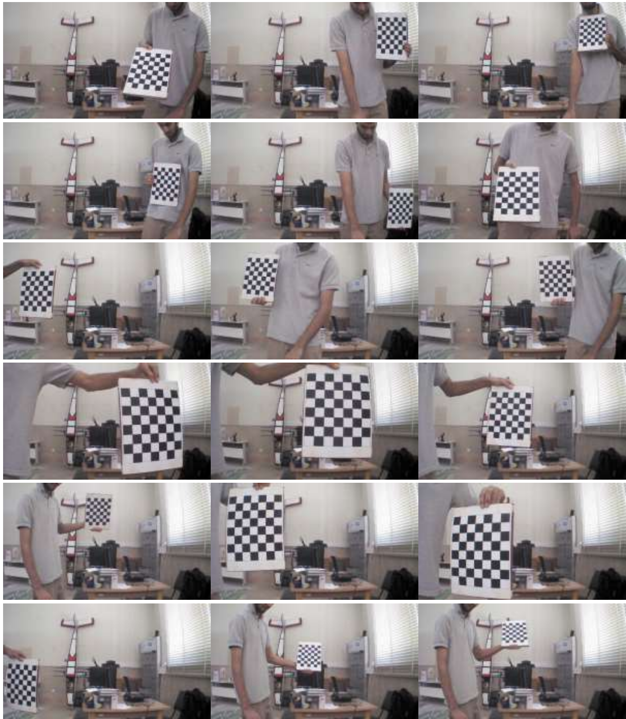
شکل 4-4 فرآیند کالیبراسیون دوربین ربات
