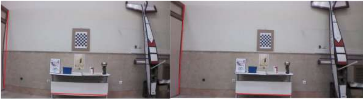
شکل 4-43 مقایسه تصویر کالیبره شده (راست) و تصویر خام (چپ)
