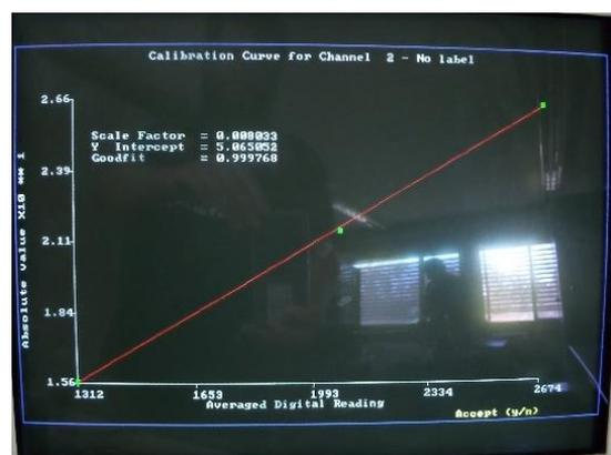
Figura 4.24 - Curva de calibração
