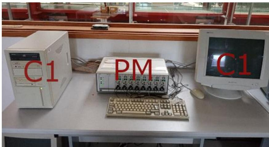
Figura 4.15 - Sala de Comando – C1 -Computador que corre o programa de recolha de dados; PM – Monitor das sondas de nível
