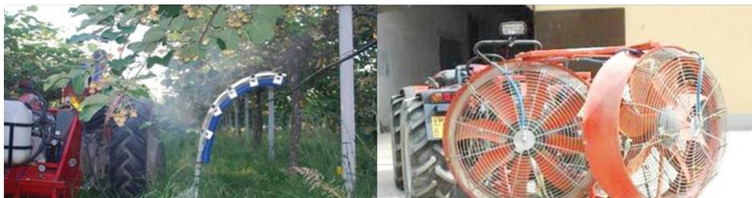
Figura 23. Máquinas utilizadas para polinização por vento em pomares de kiwi (Fonte: Tacconi *et al.*, 2016).
