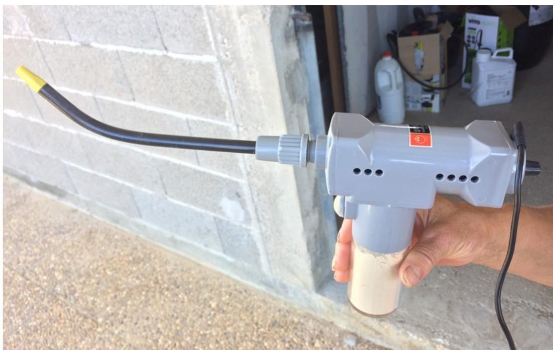
Figura 26. Dispositivo portátil de polinização assistida (Fotografia: Sílvia Castro).
