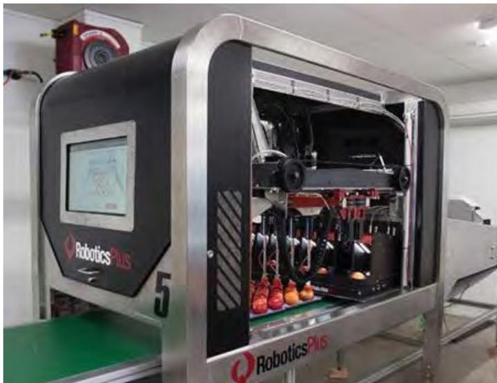
Figura 56. Robotics Plus, robô de embalagem de maçã, sendo testado para Kiwi (Fonte: <https://www.roboticsplus.co.nz/>).
