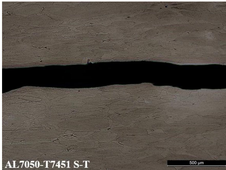
Figura 5.4 Provete C(T) com fenda, segundo a direção S-T, obtida por microscopia ótica. Adaptado de (Jesus et al., 2022)
