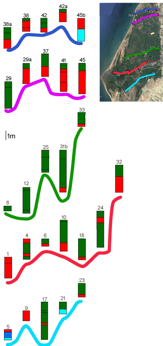
Fig. 9. Perfis E-W mostrando a sucessão sedimentar nos domínios mais superficiais do delta. Fig. 9. E-W profiles showing the uppermost sedimentary succession of the delta.
