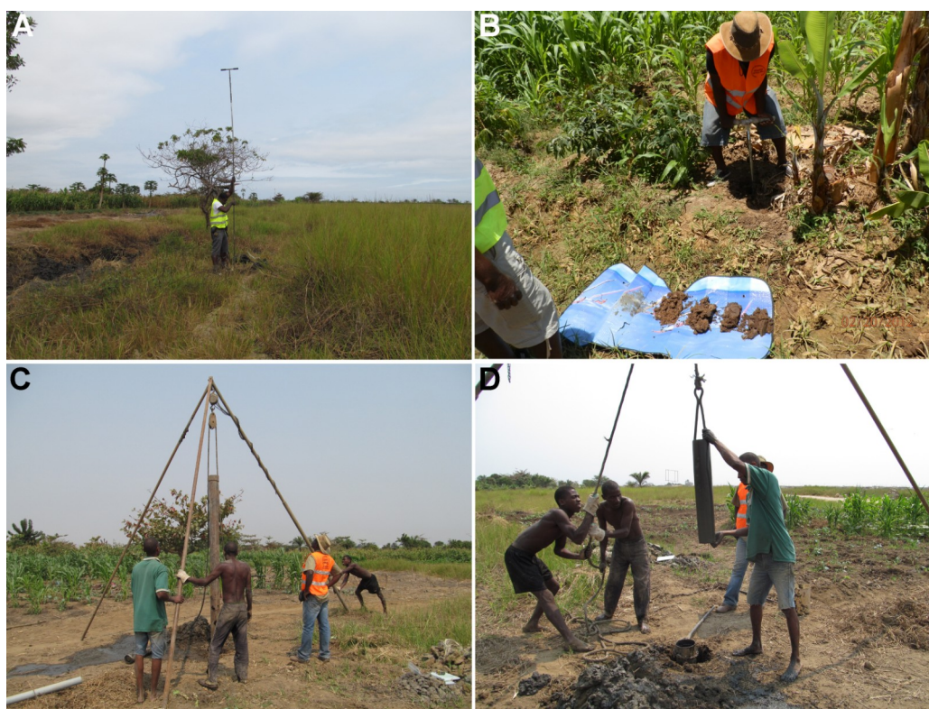
Fig. 4. Imagens da realização dos furos no delta do Catumbela. (A e B) Furos curtos com trado manual; (C e D) Furos longos obtidos por percussão mecânica.
