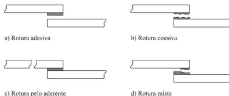
Figura 2.2. Modos de rotura em juntas coladas [9]
