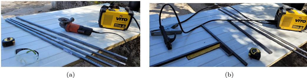
Figura 2.4: Material usado na construção [Ferros metálicos de 16 milímetros, rebarbadora Black & Decker, aparelho de soldar Vito, óculos de proteção e fita métrica ] (a) Corte dos ferros com as medidas projetadas e uso de um esquadro para garantir a esquadria de 90° da estrutura, durante o procedimento de soldagem.
