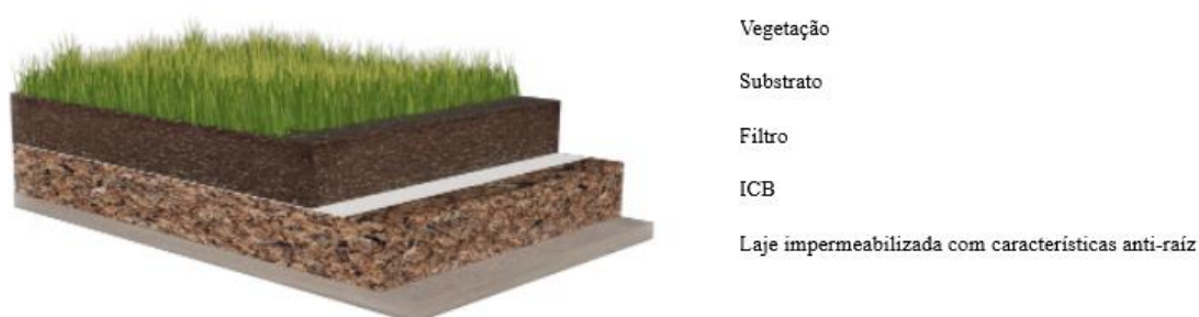
Figura 3.3 - Composição da cobertura verde estudada (sem escala). Adaptado de (Itecons, 2018).
