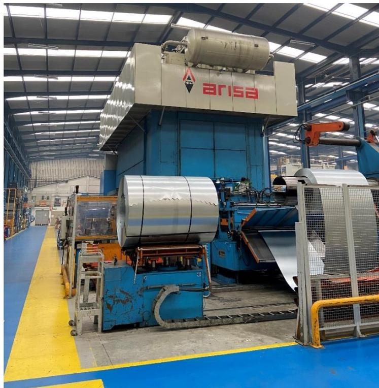
**Figura 4.** Prensa P1250TA1 com alimentação da matéria-prima em forma de bobina.
