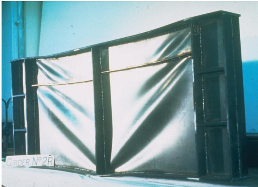
Figura 2.26: Relação entre esbelteza de placa e o esforço de compressão - imagem retirada do livro [ITEA(Tomo 10)]
