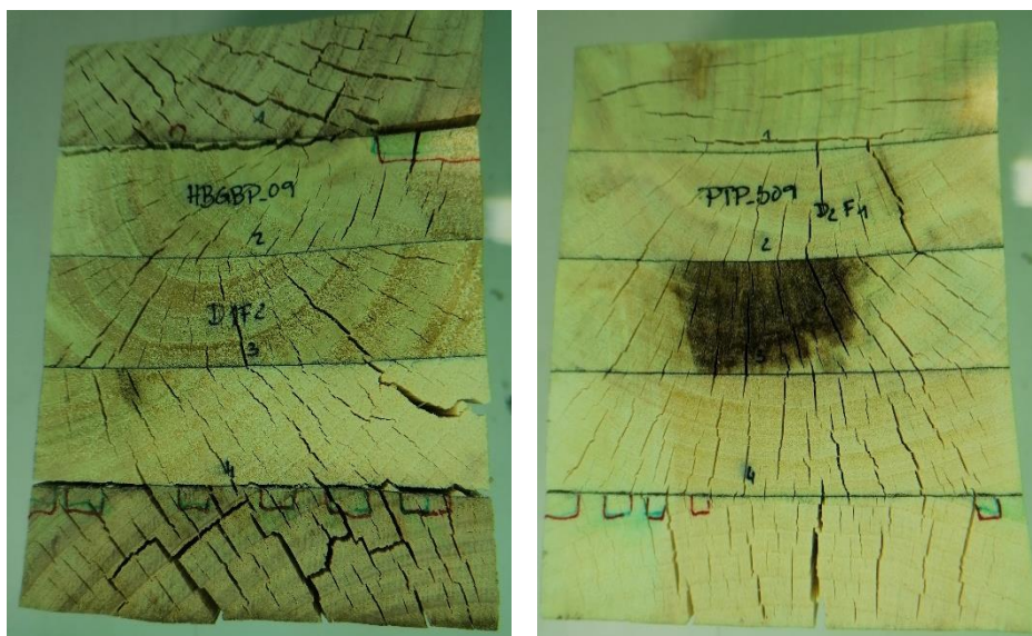
Figura 4.19 - Delaminações após o 3º ciclo, provete HBGBP (à esquerda), provete PTP (à direita).
