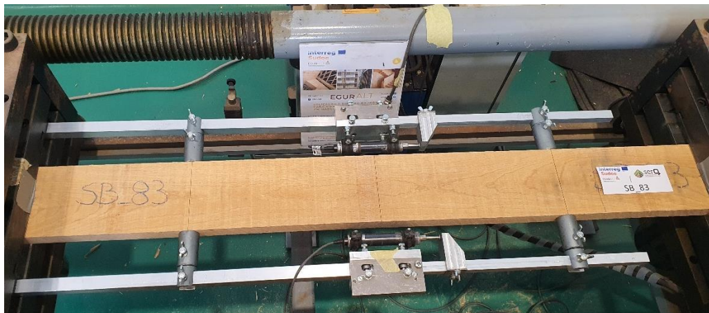
Figura 3.3 - Configuração de ensaio para determinação do módulo de elasticidade em tração paralela às fibras de uma tábua de Faia.
