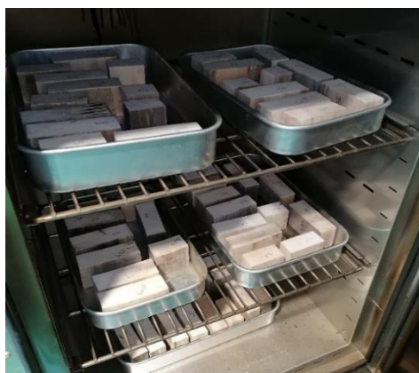
Figura 3.5 - Secagem em estufa para determinação do teor de água.
