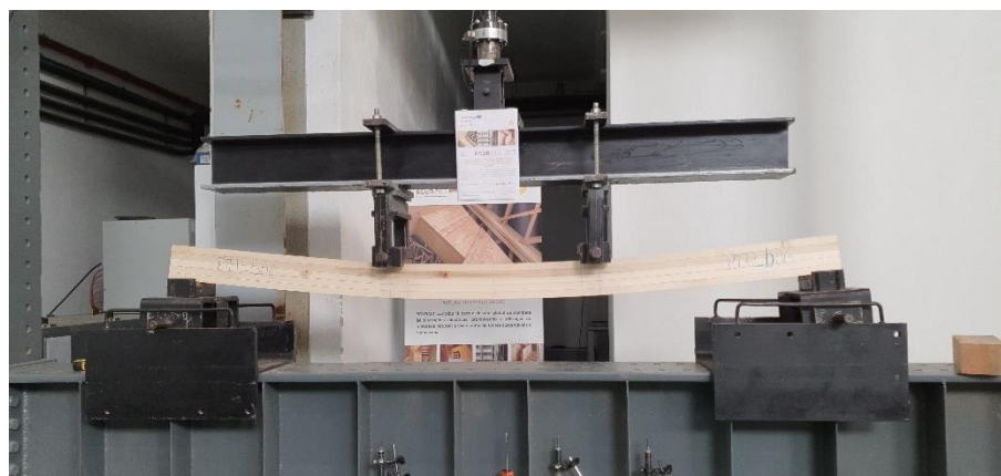
Figura 4.10 - Viga de Choupo durante o procedimento de carga (ensaio de resistência à flexão).
