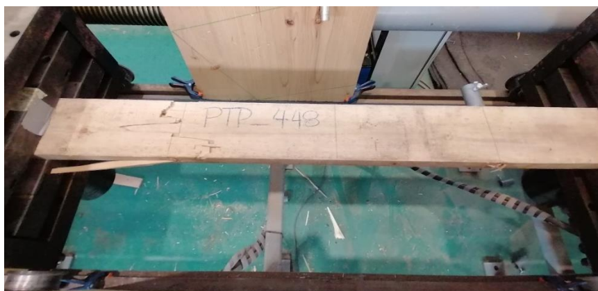
Figura 3.4 - Tábua de choupo após rotura no ensaio de resistência à tração paralela às fibras.
