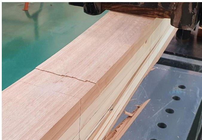
Figura 4.13 - Pregas de compressão numa viga HBGBP.
