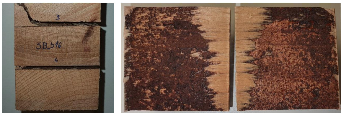
Figura 4.22 - Provete SB_b16 após rotura no ensaio de resistência ao corte da linha de cola visto do topo (à esquerda) e vista da linha de cola 4 (à direita).
