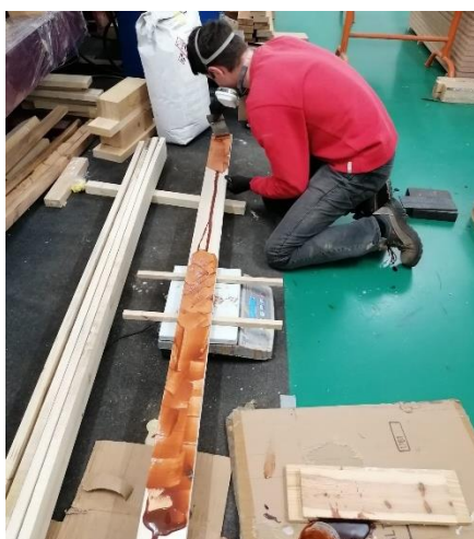
Figura 4.6 - Aplicação de cola com espátula denteada e controlo da quantidade de cola por pesagem.
