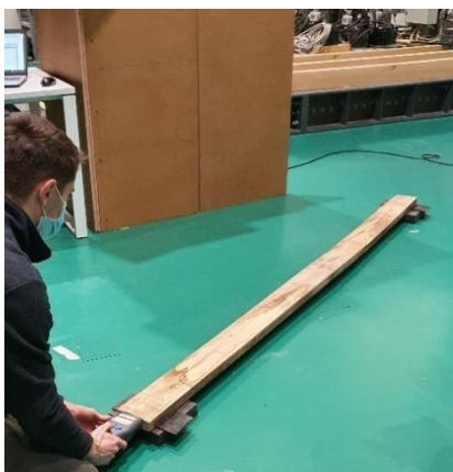
Figura 3.1 - Caracterização mecânica não destrutiva com recurso ao MTG.
