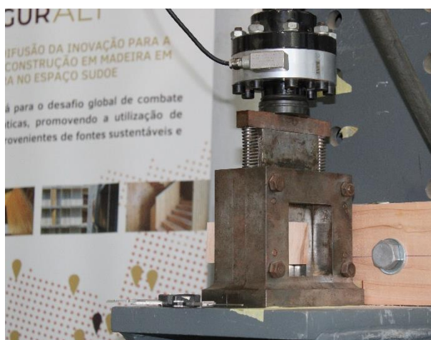
Figura 4.20 - Layout de ensaio de resistência ao corte de uma linha de cola.
