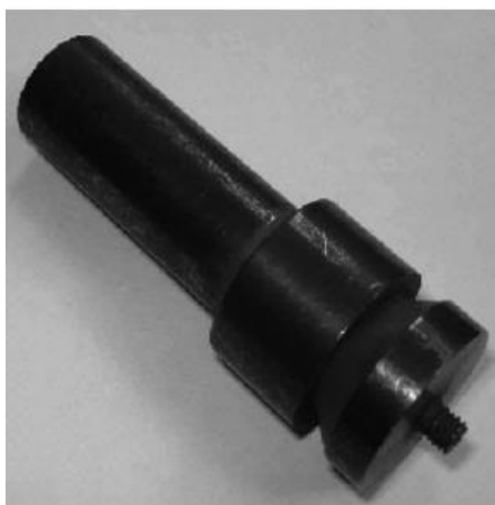
Figura 2.4. Ferramenta convencional com base larga (Adaptado de [30]).
