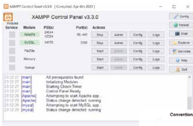
Figura 39 - XAMPP, um pacote de servidores, que inclui banco de dados MySQL e Apache, com suporte para linguagens PHP
