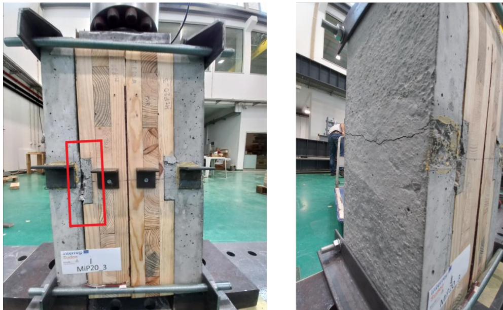
Figura 3.11 - Modos de rotura do provete MiP20_3
