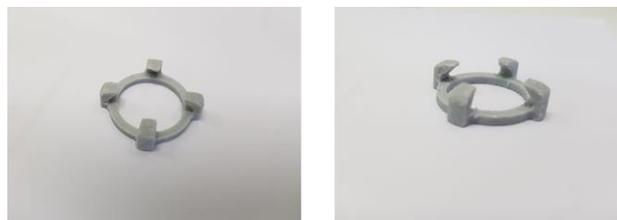
Figura 27: Suporte elaborado para a aquisição simultânea de imagens SHG em transmissão e reflexão, para córneas humanas inteiras.
