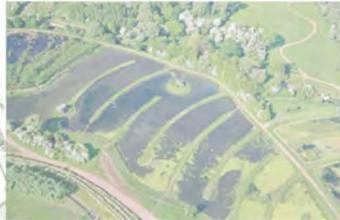
O projeto combina a objetivo principal de purificação da água, através de filtração por um processo natural, com a reconstrução de um ambiente natural húmido e que, por sua vez, permite o aumento da biodiversidade local, num local que havia recentemente sido utilizado como uma mina de carvão.
