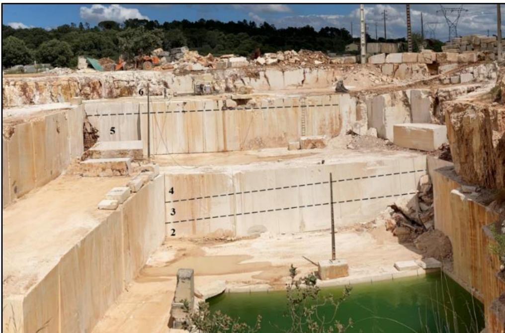
**Figura 24:** Sequência do material calcário identificado na pedreira EM&R.
