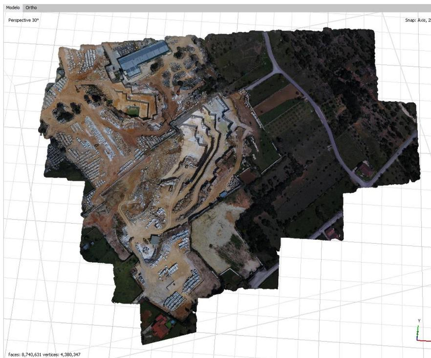
**Figura 16** – Imagem correspondente à construção da malha poligonal 3D.
