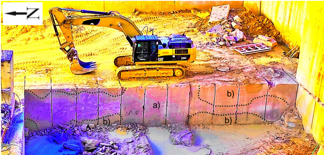
Figura 35 - Área de desmonte respeitante à TRE 3, com a delimitação do calcário mais azul (a)) e do mais creme (b)).
