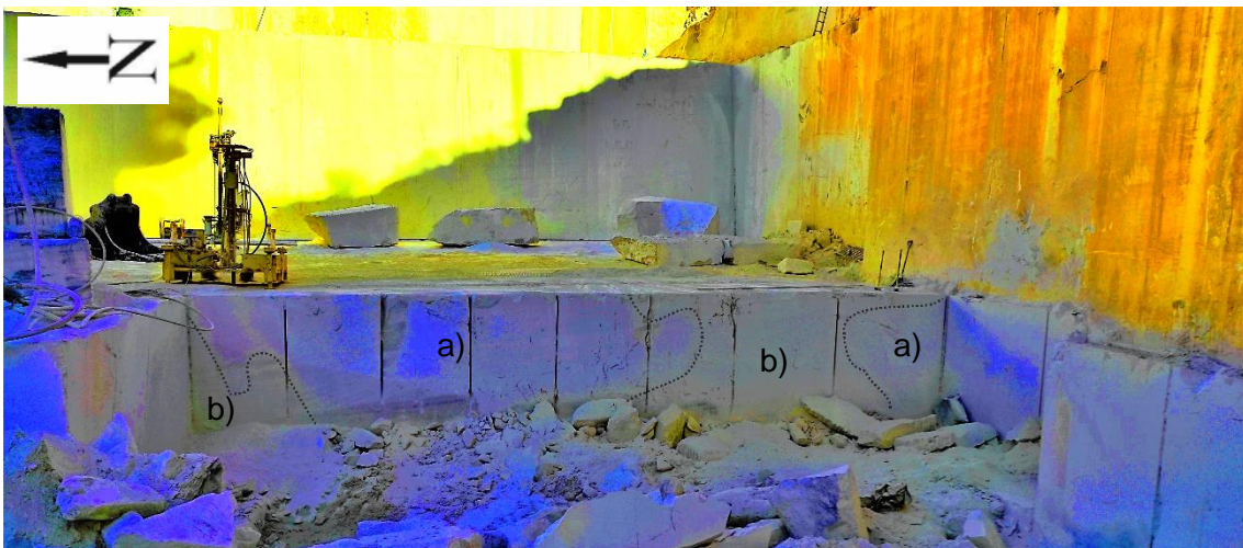
Figura 34 - Área de desmonte respeitante à TRE 2, com a delimitação do calcário mais azul (a)) e do mais creme (b)).
