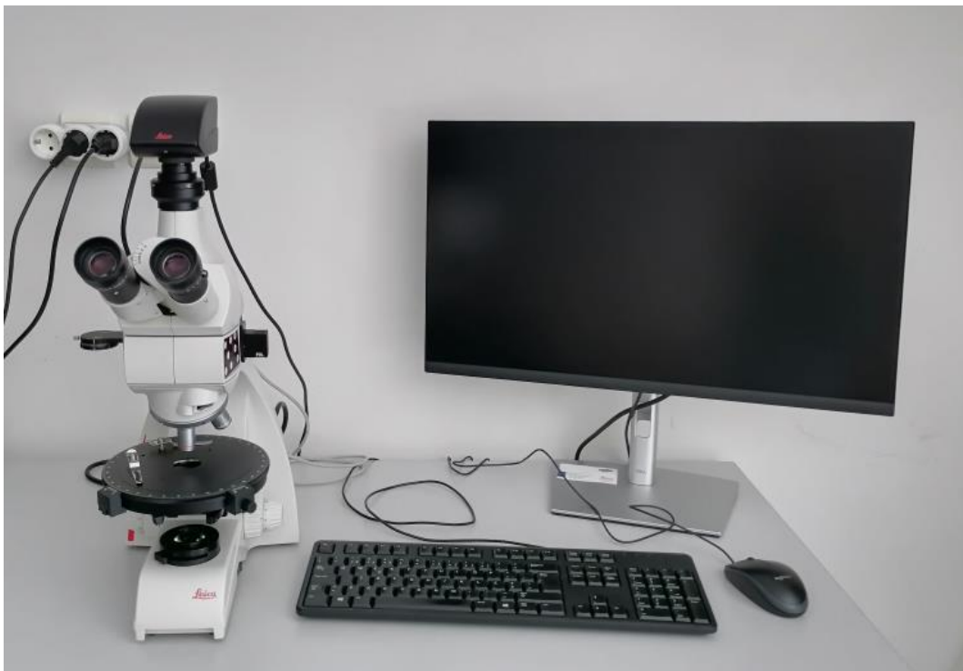
Figura 19 - Microscópio ótico de reflexão LEICA DM750P utilizado nas observações petrográficas.
