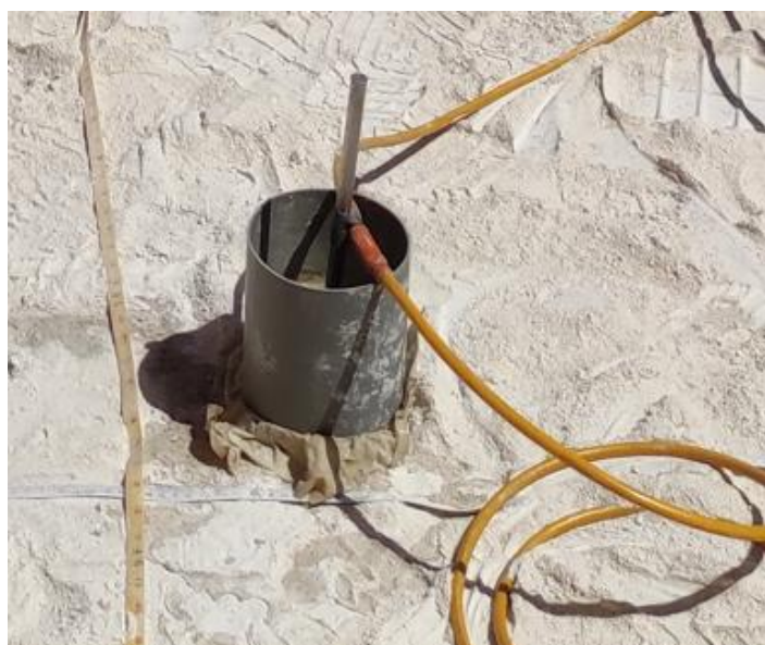
Figura 13 – Elédrodo e recipiente constituído por um tubo de plástico (PVC) com uma base porosa (pano + esponja), preenchido com material arenoso e regado com água salgada.
