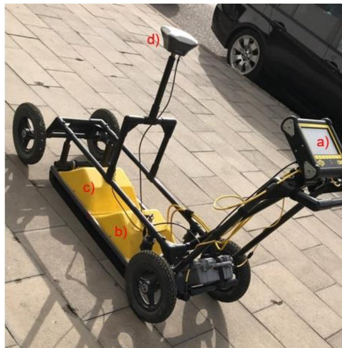
Figura 16 - Sistema GPR utilizado, da empresa Sensors & Software Inc. a) unidade de controlo digital; b) antena transmissora; c) antena recetora; d) GPS.
