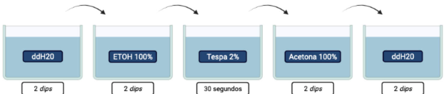
Figura 24- Esquema representativo do protocolo de preparação de lâminas em Tespa . Figura produzida através da aplicação BioRender.
