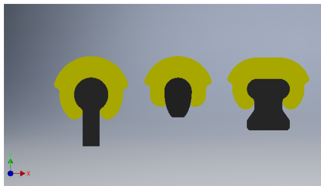
Figura 22: Secções transversais das barras de Hader , Dolder e experimental com o clipe correspondente (da esquerda para a direita).
