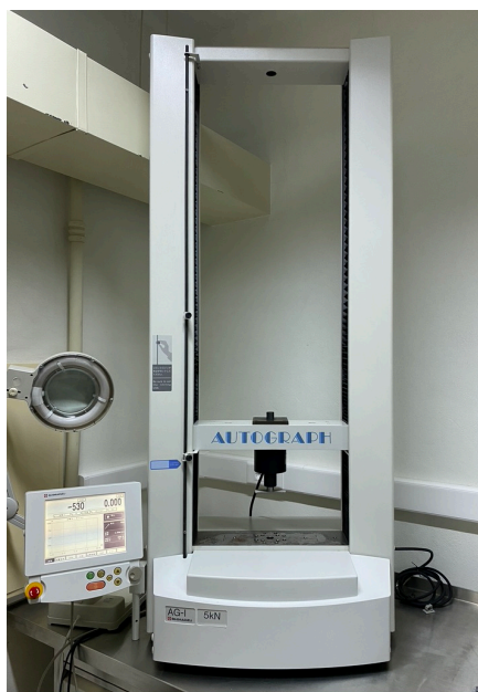
Figura 36: Máquina de testes universais AG-I versão 3.80 (Shimadzu®, Quioto, Japão).
