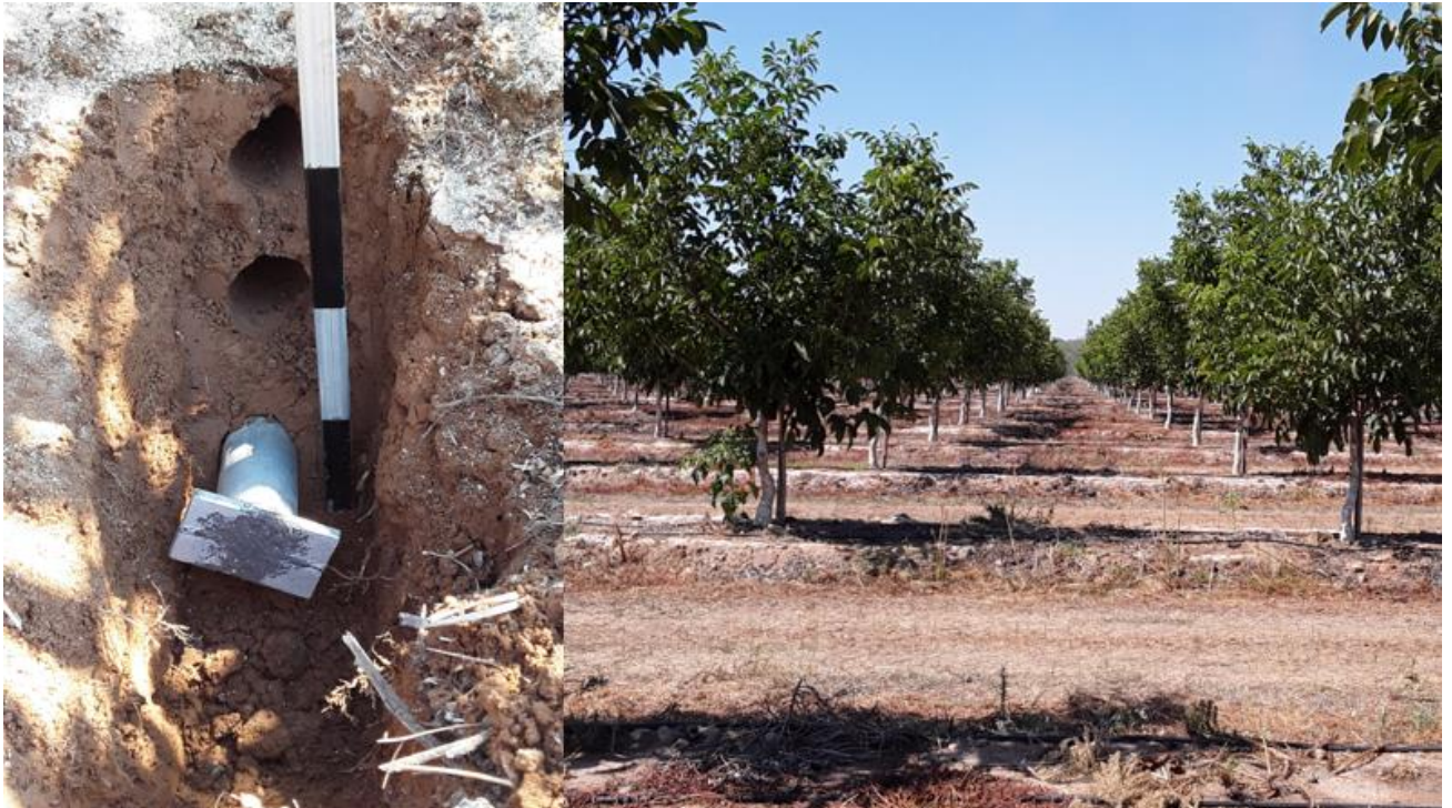
Figura 8: Recolha de amostras de solo aos 10, 20 e 30 centímetros de profundidade em pomares intensivos
