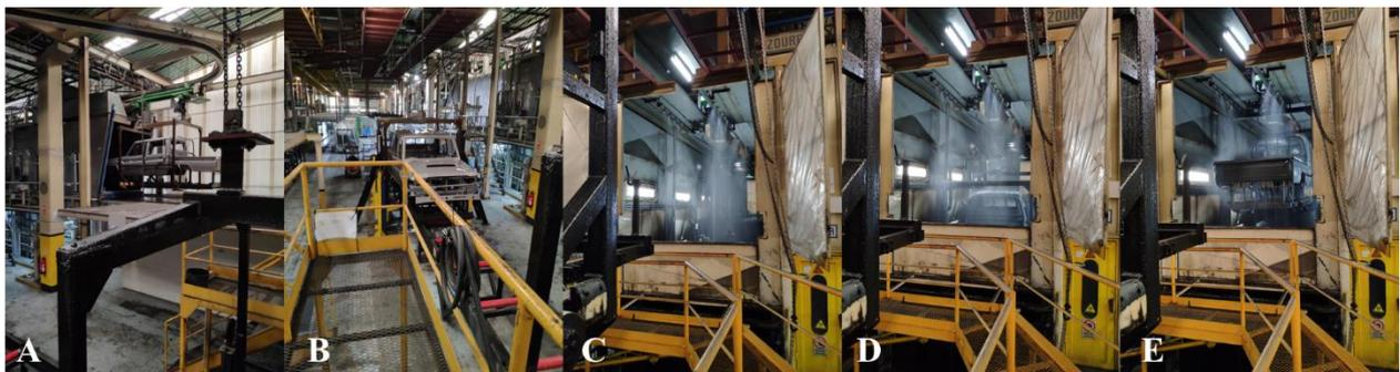
**Figura 4.7** Saída do PT (A), Posto de lavagem Pré- ED (B), Mergulho no banho do ED (C), Saída do banho do ED (D), Chuveiros pós ED (E).
