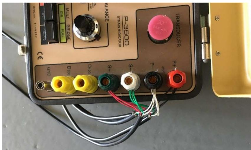
**Figura 4.8.** Ligações entre as células e o osciloscópio digital.
